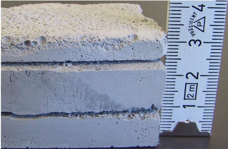
Abbildung 4.22: Prisma mit ausgeprägtem horizontalem Schichtaufbau durch Drainage und Sedimentation
