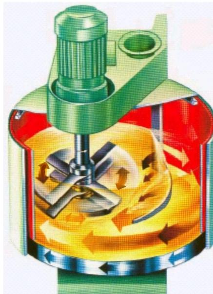
Abbildung 5.1: Intensivmischer, Quelle Fa. Eirich, verändert
