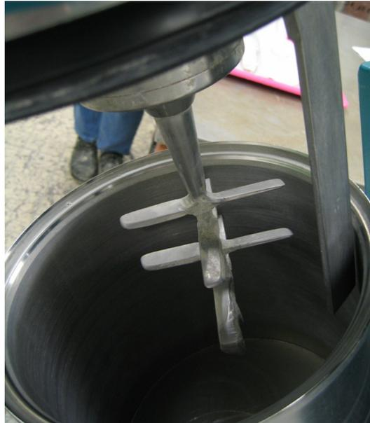
Abbildung 5.2: Mischwerkzeug des Intensivmischers
